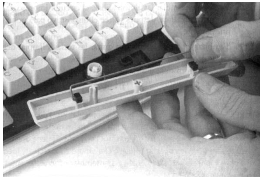
Cómo colocar el alambre de retención.
